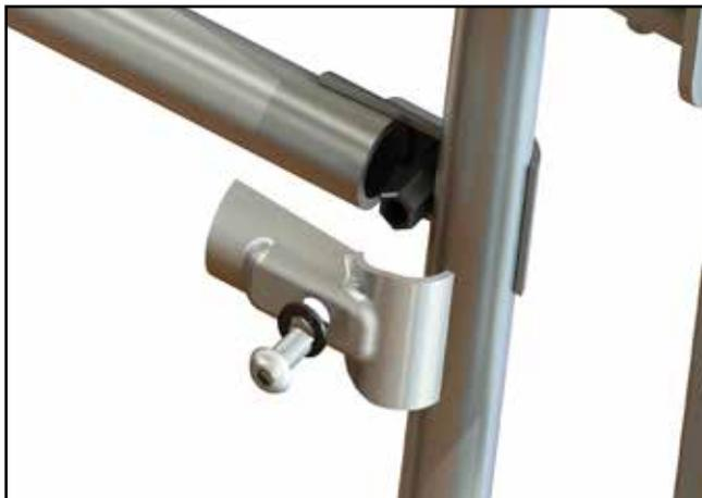
**M.** Halten Sie einen Teil des anderen Halbschalenverbinders an das gegenüberliegende Rohr der Tür, setzen Sie nun das Rohr ein und fügen Sie das andere Teil des Halbschalenverbinders an. Benutzen Sie den 6 mm Sechskantschlüssel, um die M10 Schrauben in der Kupplungsmutter des Verbinders festzuziehen.
