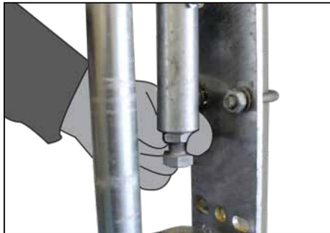
**J.** Lösen Sie die Sicherungsmutter wie dargestellt, um das Scharniergelenk zu spannen.
