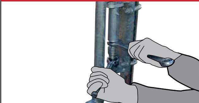
**N.** Nachdem die Sicherheitstür komplett geschlossen ist, ziehen Sie die Sicherungsmutter fest, um die Spannung zu halten.
