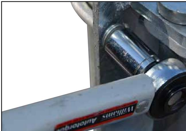
**C.** Ziehen Sie alle Muttern/U-Bügel mit dem 13 mm oder 17 mm Steckschlüssel und dem Drehmomentschlüssel mit einem Drehmoment von 25 Nm fest.
