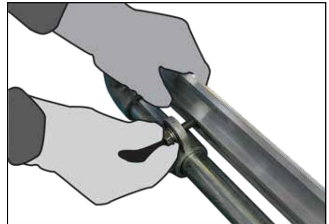
**K.** Verwenden Sie die mitgelieferten M10 Muttern, Schrauben und Unterlegscheiben, um die Fußleiste am Bodenrohr der Tür zu montieren.
