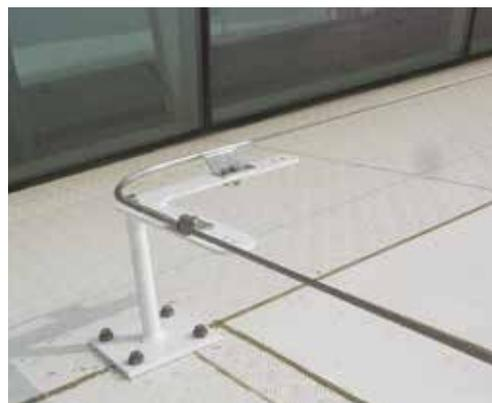
Die feuerverzinkten Verankerungen **POSTANKA** werden mithilfe eines Standard-Berechnungsprogramm an die Anforderungen von EN 795 Class A2 bzw. die Anforderung bezüglich 5.000 lbs (22,2 kN) der OSHA angepasst.
