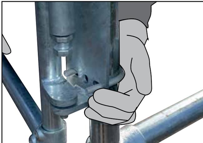
**C.** Führen Sie den unteren U-Bügel um den Stützfuß bzw. um die Stützstruktur durch die unteren Löcher der Befestigungsplatte.
