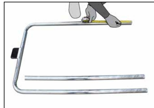
**H.** Dividieren Sie das Maß welches Sie in Schritt F aufgenommen haben durch 2. Messen Sie diesen Abstand, und markieren Sie alle drei Rohre entsprechend der Abbildung. Um sicherzustellen dass beide Gates gleich lang sind, muss das Maß an beiden Gates abgenommen werden.
