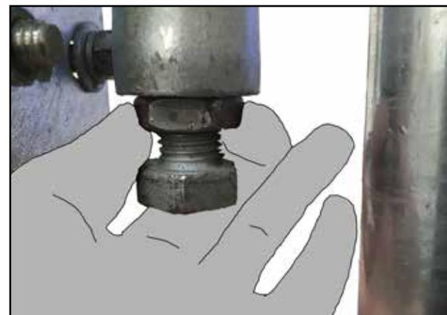
**K.** Lösen Sie die Sicherungsmutter wie dargestellt, um das Scharniergelenk zu spannen.
