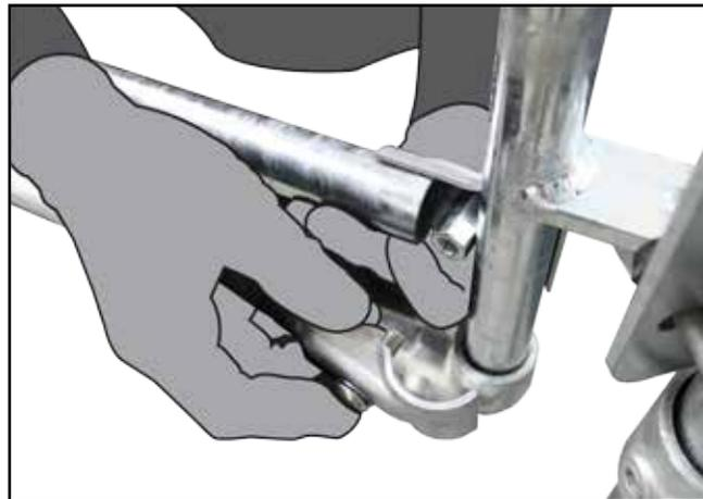
**P.** Setzen Sie einen Teil des anderen Halbschalenverbinders an das gegenüberliegende Rohr der Tür, setzen Sie das Rohr ein und fügen Sie das andere Teil des Halbschalenverbinders an. Benutzen Sie den 6 mm Sechskantschlüssel um die M10 Schrauben in der Kupplungsmutter des Verbinders festzuziehen.
