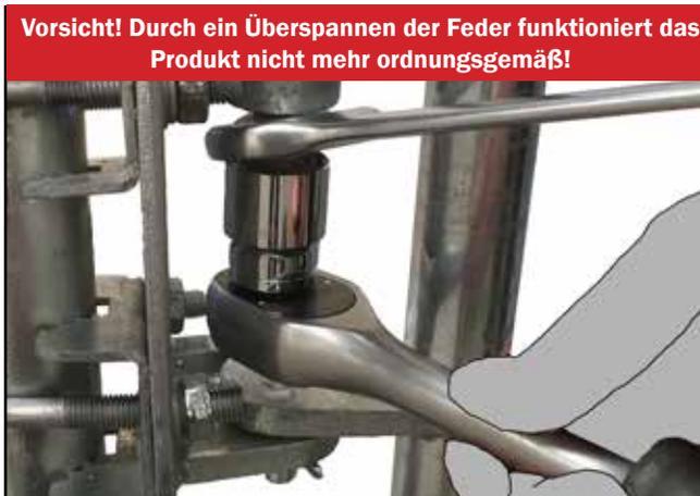
**Vorsicht! Durch ein Überspannen der Feder funktioniert das Produkt nicht mehr ordnungsgemäß!**
