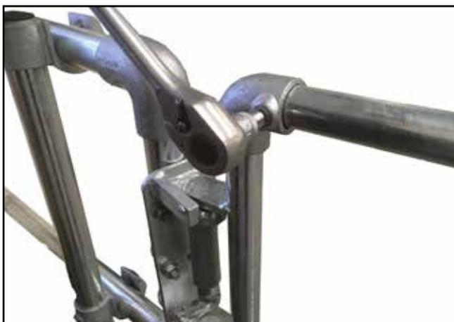
**J.** Setzen Sie das obere und untere Rohr wieder in die Rohrverbinder ein. Stellen Sie sicher, dass sich der Anschlag auf der richtigen Seite des Stützfußes befindet. Richten Sie die Tür mit einer Wasserwaage aus. Ziehen Sie die Madenschrauben mit 39 Nm fest. Benutzen Sie einen Drehmomentschlüssel mit Innensechskantaufsatz. **Wiederholen Sie Schritt G-J für die Tür auf der anderen Seite.**
