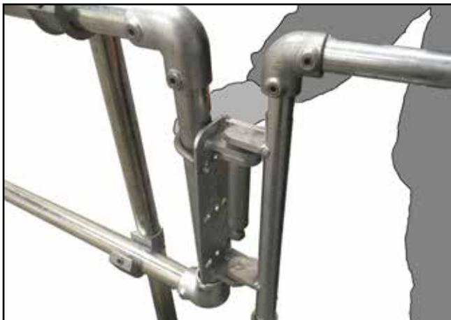
**A.** Richten Sie die Befestigungsplatte an der Innenseite der Öffnung so aus, dass die Rohre der Sicherheitstür mit der Oberkante des Sicherheitsgeländers bündig sind. Führen Sie den U-Bügel um das Stützbein bzw. um die Stützstruktur durch die oberen Löcher der Befestigungsplatte.
