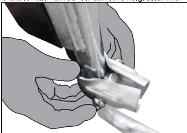
**P.** Montieren Sie einen der Halbschalenverbinder am unteren Teil der Tür, knapp über der Biegung des unteren Rohres, und setzen sie das mittlere Rohr ein. Benutzen Sie den 6 mm Sechskantschlüssel um die M10 Schrauben in der Kupplungsmutter des Verbinders festzuziehen.
