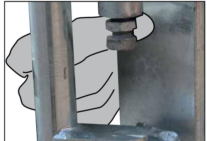
**K.** Lösen Sie die Sicherungsmutter wie dargestellt, um das Scharniergelenk zu spannen.
