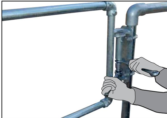
**M.** Ziehen Sie die Schraube mit einem 24 mm Ringschlüssel zu, bis sich die Sicherheitstür komplett schließt. (Anmerkung: Möglicherweise müssen Sie gegenkontern, während Sie die Ratsche verwenden).
