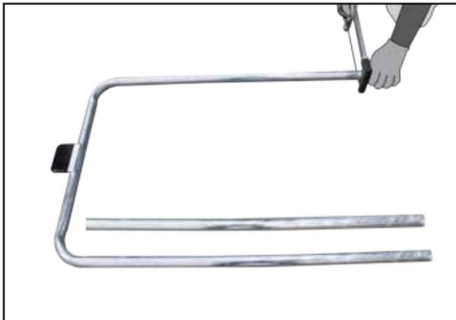
**I.** Schneiden Sie vorsichtig alle drei Türrohre mit einer Metallsäge o. ä. wie dargestellt. Sprühen Sie die Kanten zum Schutz vor Korrosion mit Zinkspray o. ä. ein. Setzen Sie die Rohre in die Rohrverbinder zurück.
