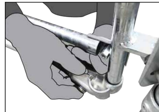
**Q.** Setzen Sie einen Teil des anderen Halbschalenverbinders an das gegenüberliegende Rohr der Tür, setzen Sie das Rohr ein und fügen Sie das andere Teil des Halbschalenverbinders an. Benutzen Sie den 6 mm Sechskantschlüssel um die M10 Schrauben in der Kupplungsmutter des Verbinders festzuziehen.
