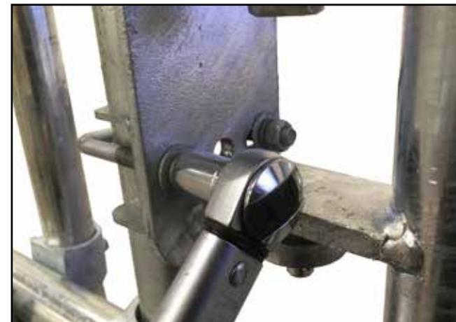
**E.** Ziehen Sie alle Muttern/U-Bügel mit dem 13 mm oder 17 mm Steckschlüssel und dem Drehmomentschlüssel mit einem Drehmoment von 25Nm fest.
