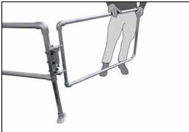
**L.** Öffnen Sie die selbstschließende Sicherheitstür mit der Hand um 45 Grad aus der geschlossenen Position.
