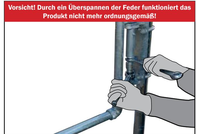
**Vorsicht! Durch ein Überspannen der Feder funktioniert das Produkt nicht mehr ordnungsgemäß!**
