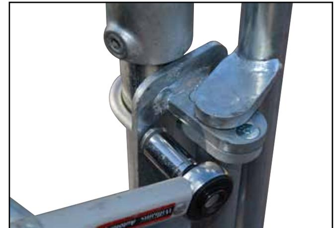
**E.** Ziehen Sie alle Muttern/U-Bügel mit dem 13 mm oder 17 mm Steckschlüssel und dem Drehmomentschlüssel mit einem Drehmoment von 25 Nm fest.
