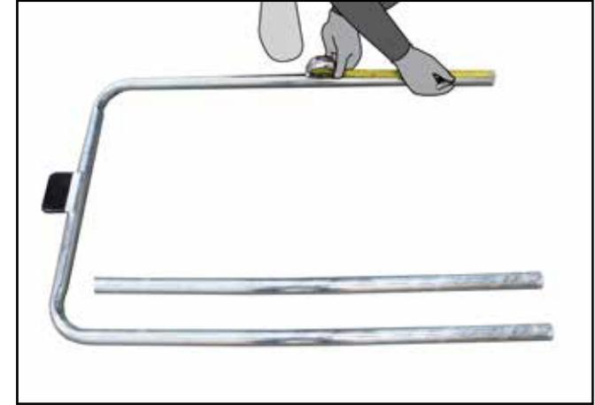
**H.** Messen Sie den Abstand, welches Sie in Schritt F aufgezeichnet haben, und markieren Sie alle drei Türrohre entsprechend der Abbildung.
