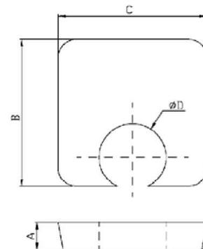
BeamClamp - Trägerklemmverbindung
