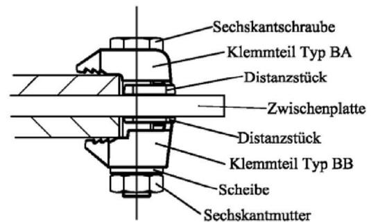
BeamClamp - Trägerklemmverbindung
