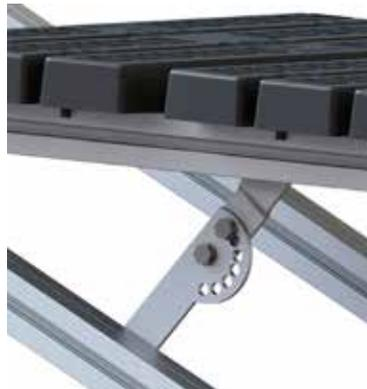
3) Mit den kundenspezifischen Scharnieren kann der Querlaufsteg frei rotieren. Die Scharniere werden mit 2 x M8 Schrauben / Muttern / normalen Unterlegscheiben und Federingen an den Aluminiumprofilen angebracht.
