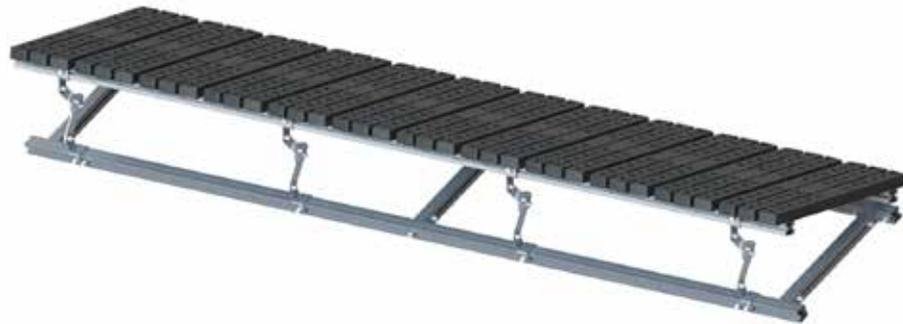
1) Mit den Dreharmen kann der Benutzer den Winkel der Plattform zur Horizontalen des Daches einfach einstellen. Dazu muss nur der Führungsbolzen entfernt, der Winkel eingestellt und der Bolzen wieder eingesetzt werden.
