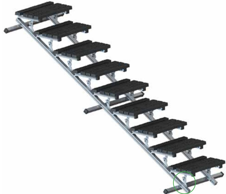
1) Mit den Dreharmen kann der Benutzer den Winkel der Stufen zur Horizontalen mit minimalem Aufwand einstellen. Dazu muss nur der Führungsbolzen entfernt, der Winkel eingestellt und der Bolzen wieder eingesetzt werden.
